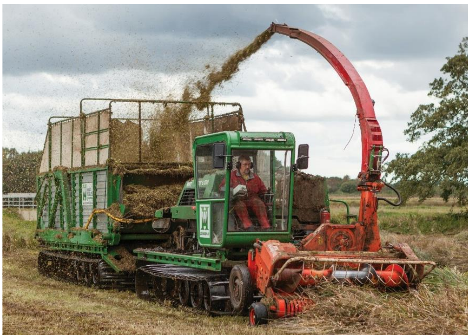
Abbildung 4: Raupenfahrzeug mit Mähaggregat und Auffangkorb, Greifswald Moor Centrum, Anbaue und Ernte von Paludikulturen- Ertragserwartungen und Ansprüche, 05.09.2022, Foto: T. Dahms
